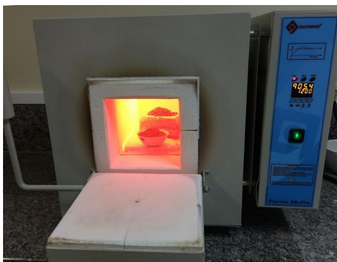
Figura 13 - Misturas inseridas em mufla a 900 °C para fusão.
