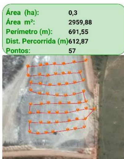
Figura 6 - Representação dos pontos demarcados por GPS na célula C1 da AAMOL.
