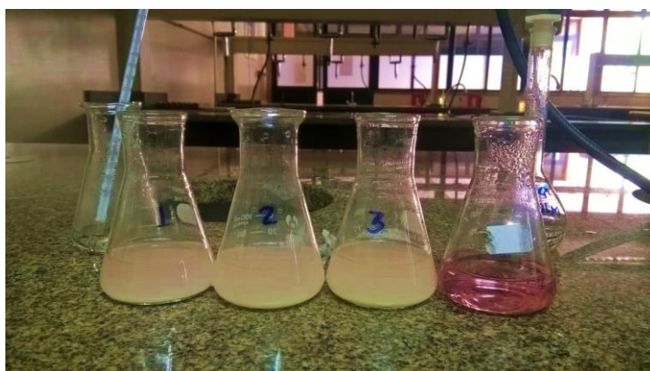
Figura 14 - Ensaio de resistência hidrolítica dos vidros.
