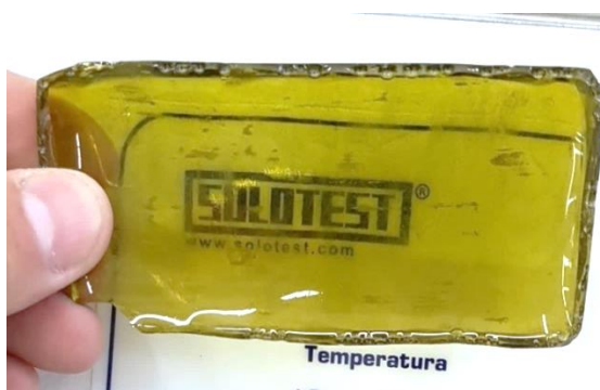
Figura 19 - Vidro L3, evidenciando a baixa distorção na imagem.
