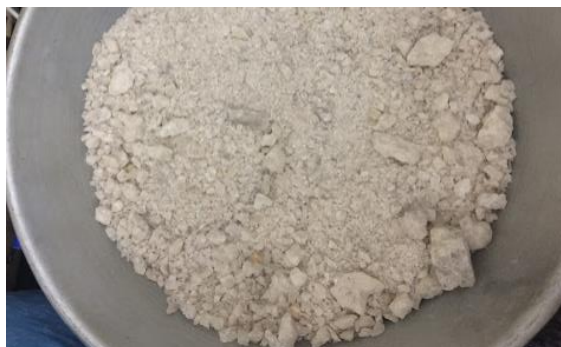
Figura 9 - Resíduo de quartzito antes do processo de moagem.
