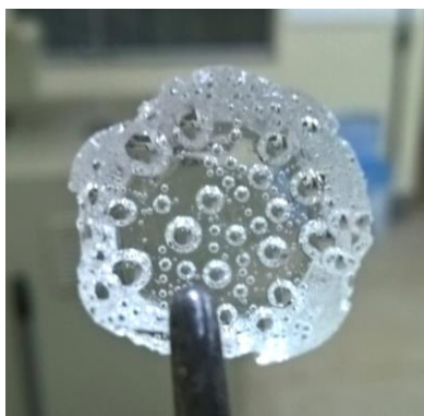
Figura 20 - Vidro de composição Q1, fundido em cadinho de platina.
