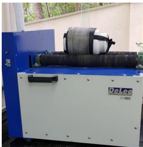
Figura 10 - Homogeneização da mistura no moinho de bolas.
