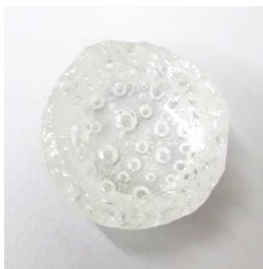
Figura 21 - Vidro Q2, fundido em cadinho de platina.
