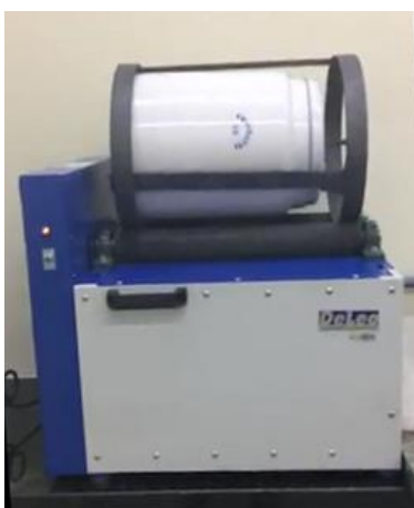
Figura 8 - Homogeneização da LBRO no moinho de bolas de porcelana.
