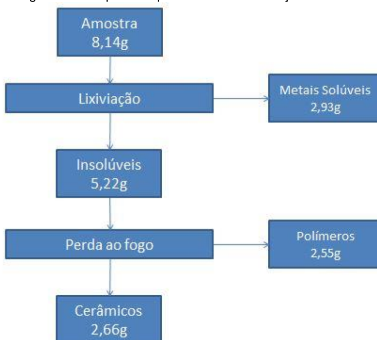
Figura 10 - Esquema representativo do balanço de massa
